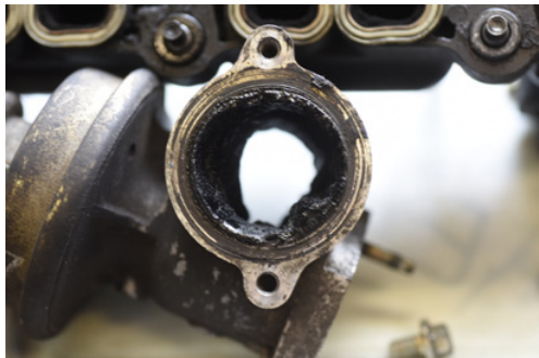
Zanesená a špatně ovladatelný ventil EGR je realita většiny starých dieselů. V tomto stavu bychom doporučili výměnu.
