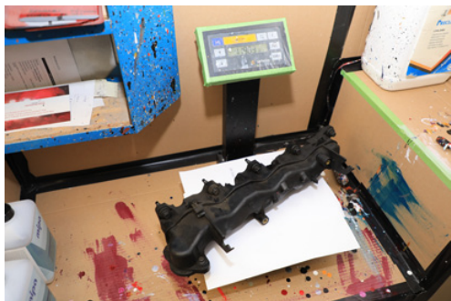
Sací potrubí jsme před testem i po něm nechali přesně zvážit. Žádná změna se ale neudála, čističí aditiva fungují ve válcích.
