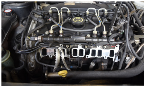
Pohled po sejmutí sacího potrubí ukazuje kanály v hlavě. I zde po letech provozu najdeme nánosy karbonu.
